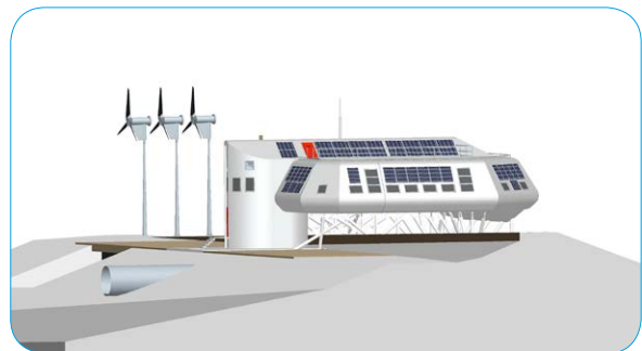
Figuur 8: Let op de buis die de ingang vormt naar de garages en tevens naar het station.
