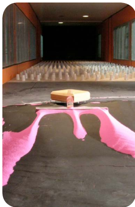
Figuur 1: De sneeuwerosie werd voor verschillende concepten getest in een windtunnel.
