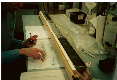
Figuur 2: Diatomeeënanalyse van een sedimentboorkern. A. Het nemen van substalen. B. Diatomeeën onder de microscoop (UGent)
