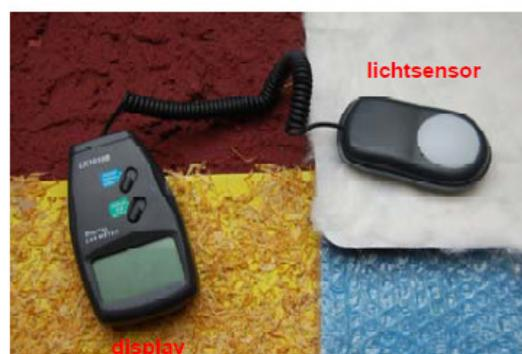
Quando la distanza tra la sorgente di luce e l'oggetto illuminato aumenta, l'intensità di luce, calcolata in unità di superficie, si riduce. Per ottenere un'accurata misurazione dell'intensità di luce, dovrai posizionare il fotometro all'altezza di lavoro. Per questo esperimento, dovrai utilizzare il tuo braccio come supporto: metti il gomito sul tavolo e forma un angolo di 90°. Dovrai tenere questa
